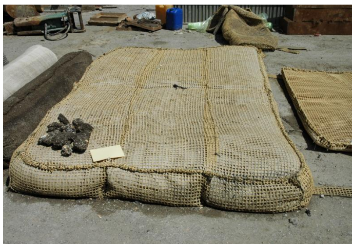
Fig. 6.2 : Burghe e materassi ad alta e media resistenza realizzati in geogriglia in fibre di poliestere e riempite con pietrame o con conchiglie o limi aggregati con legante minerale o con conchiglie sciolte
